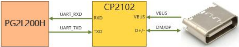
图 3-3 USB-UART 原理框图
