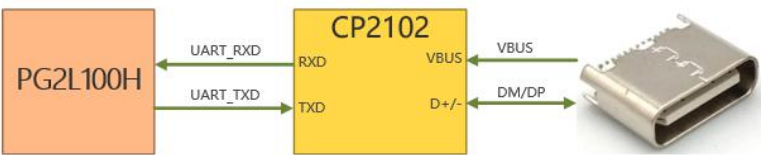
图 3-3 USB-UART 原理框图
