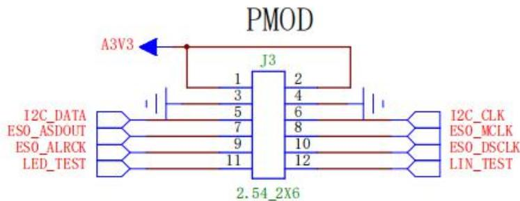
图 2 音频模块 PMOD 管脚分布图
