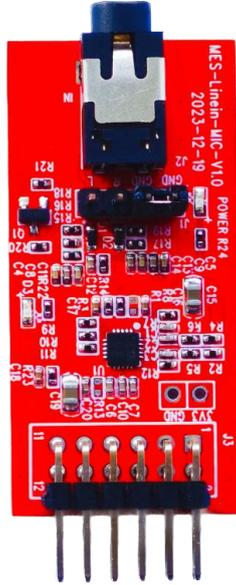
图 1 音频输入模块实物图
