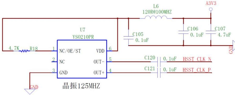
图 2-2 有源差分晶振原理图
