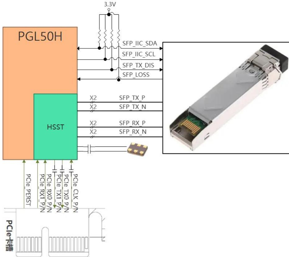
图 3-2 PGL50H HSST 功能连接图
