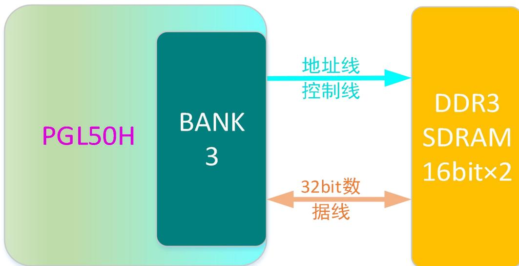
图 2-5 PGL50H 与 DDR 连接框图
