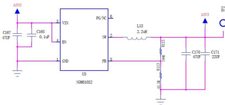
图 3-10 5V 转 3.3V 原理图
