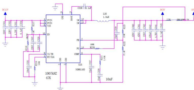
图 3-9 12V 转 5V 原理图
