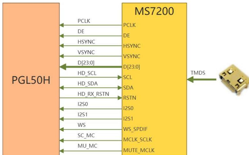
图 3-4 HDMI Receiver 连接示意图
