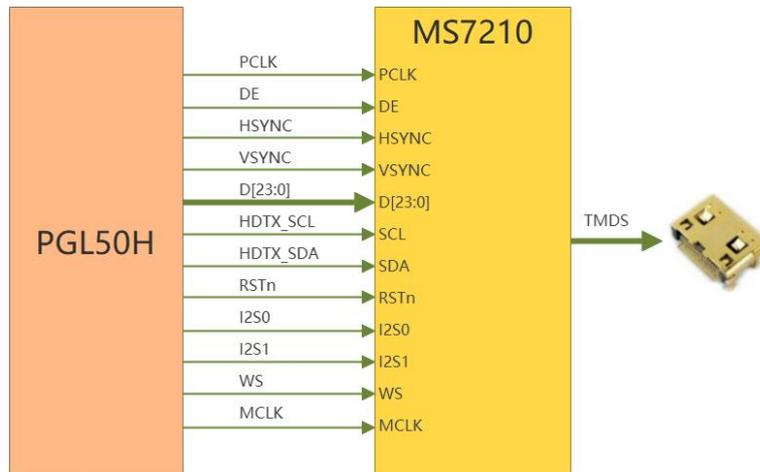
图 3-5 HDMI Transmit 连接示意图
