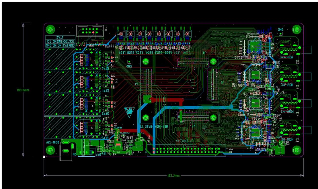
图 3-11 扩展底板尺寸结构图
