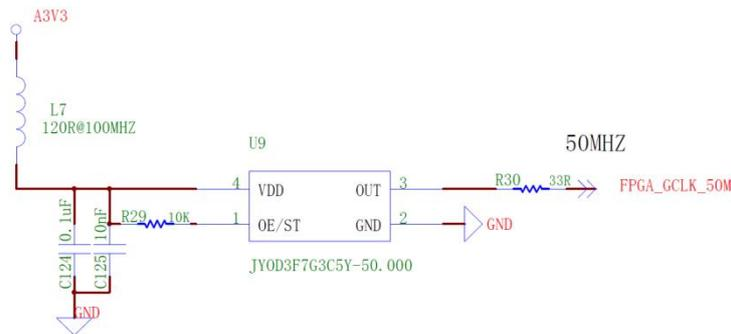
图 2-3 有源单端晶振 50M 原理图
