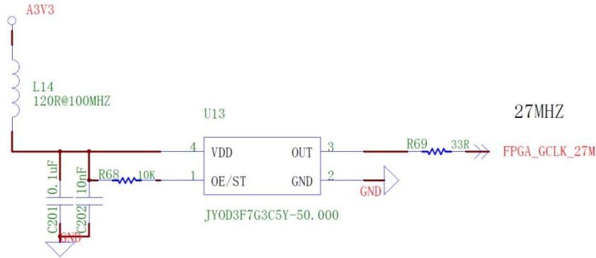
图 2-4 有源单端晶振 27M 原理图
