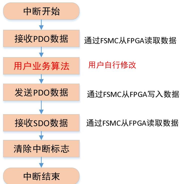
在中断过程中，fpga 和 CPU 相互交接流程如下所示，CPU 只管进行业务处理，将业务处理后结果写入/读取 FPGA，FPGA 会将数据打包发送给 PHY 中。
